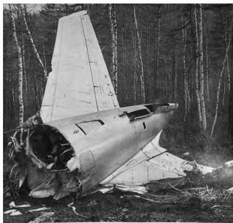
Хвостовая часть фюзеляжа (кили, стабилизаторы и кили высоты, лопки парашюта). Лежит на киле. Пята в убранный положении.
